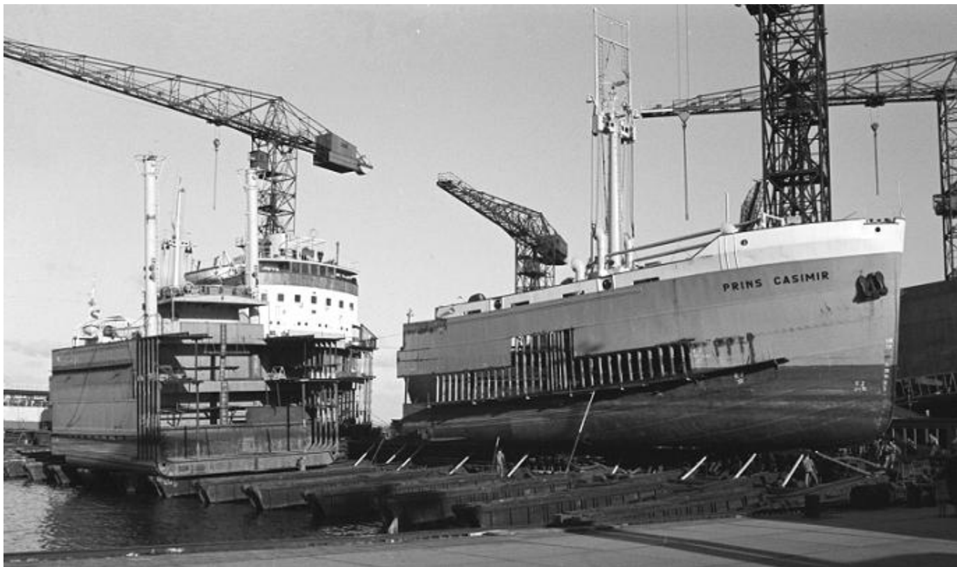
M.s. PRINS CASIMIR van de rederij Oranje Lijn op de scheepshelling van Boele Bolnes om met een tussenstuk verlengd te worden. Foto: Ary Groeneveld # 3880, 11-01-1960 Gemeente Rotterdam (Stadsarchief).
